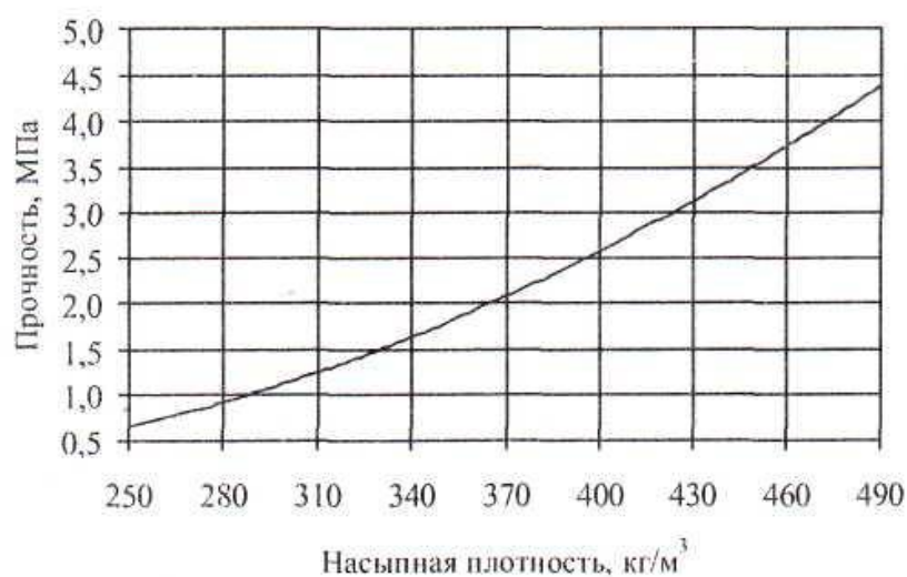
Рис. 1. Зависимость прочности керамзитового гравия от его насыпной плотности ( Y = 0,4292 + 0,193X + 0,0278X^2 , R = 0,97 )
